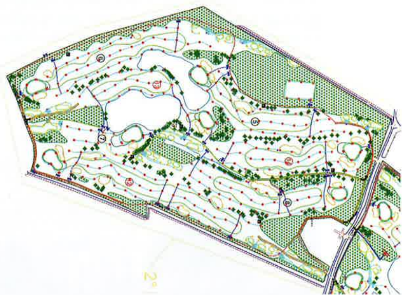
Il green del campo da golf è mantenuto verde da un complesso sistema di irrigazione costituito da 1200 bocche di erogazione dell'acqua; in rosso sono segnalate le bocche di una sezione del campo
